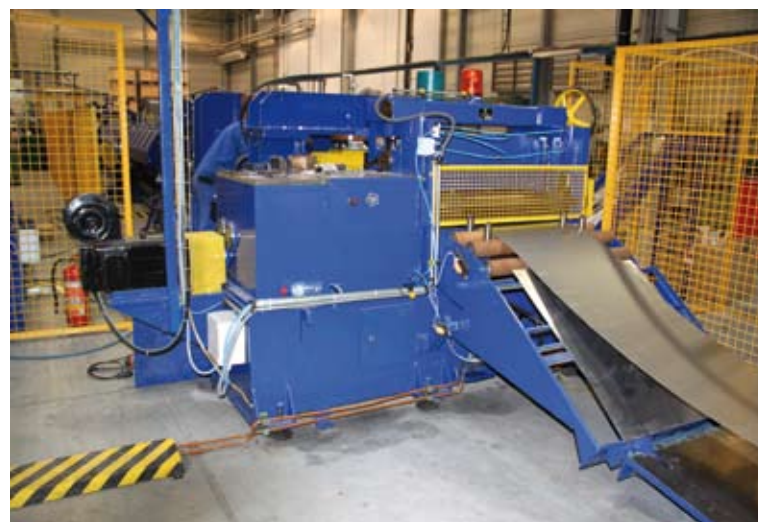
Linia do produkcji obudów do urządzeń do AGD
